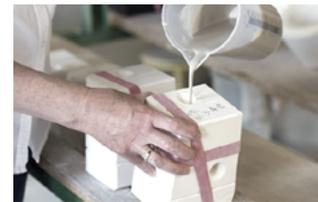
einfüllen der keramischen masse (schlicker)
